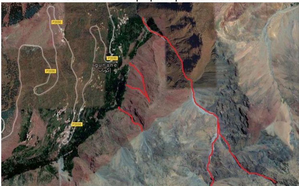
Figure 11. Ravins proposés pour correction à Igunane
