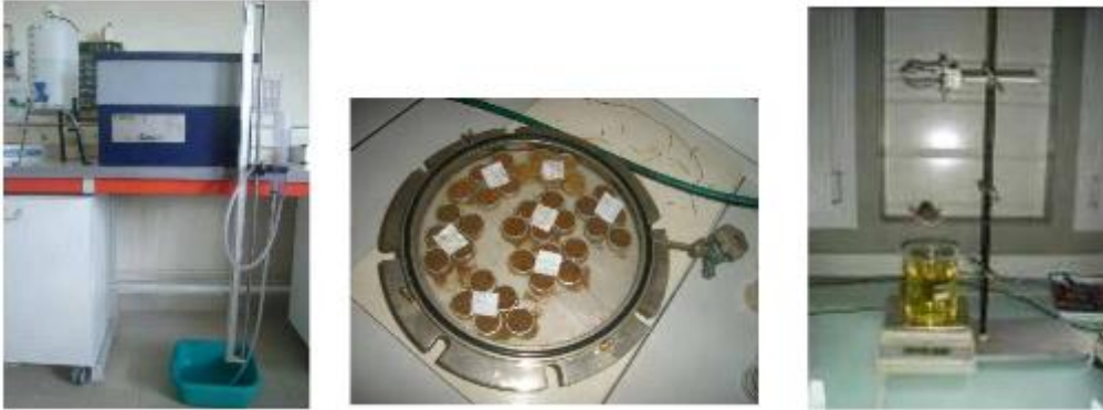
Figure 24 : Photo de la presse à membrane ou la marmite de Richard.
