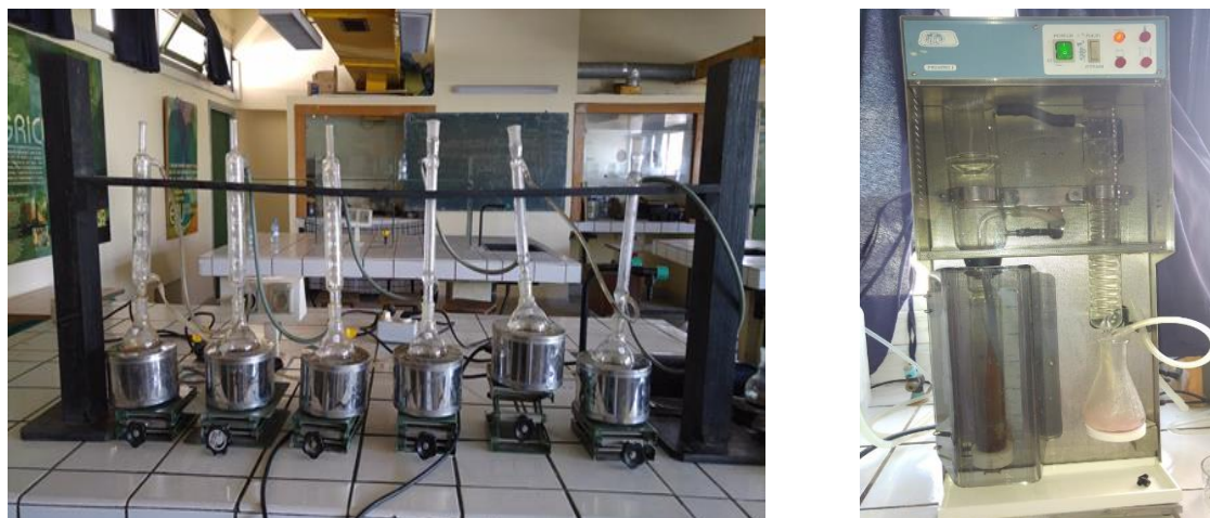
Figure 25 : Matériels de minéralisation du carbone et de l'azote (à gauche), de distillation de l'azote (à droite).
