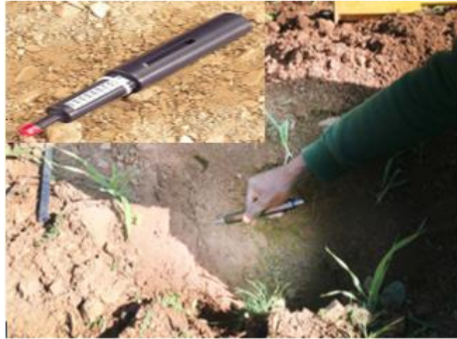
Figure 21 : Photo montrant le pénétromètre de poche (4,5 bars).
