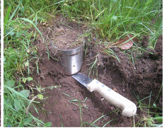
Figure 17 : Photo lors du prélèvement d'un échantillon par le cylindre.
