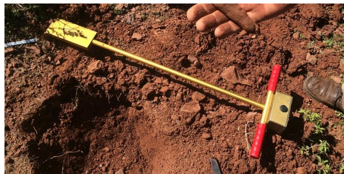
Figure 23 : Photo d'humidimètre TDR (Time Domain Reflectometer).
