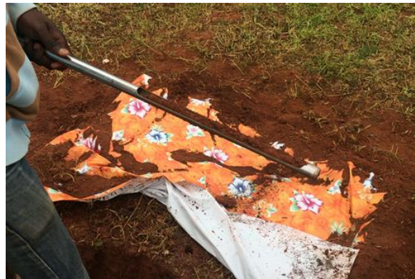
Figure 18 : Photo d'un prélèvement par la tarière.
