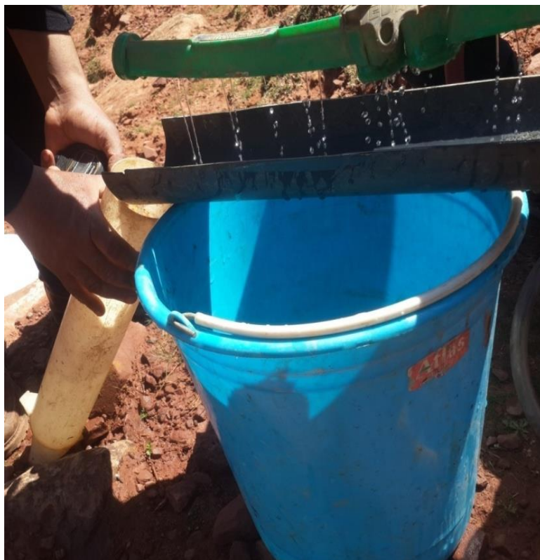
Photo 9 : Mesure de l'intensité de pluie simulée
